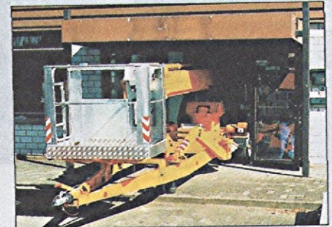
GT 25 R: geringe Durchfahrhöhe
